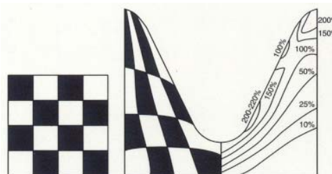
Addensamento delle deformazioni in un pezzo rullato
